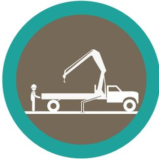
**OPERADOR INSTALA EQUIPO EN ZONA ESTABILIZADA, UTILIZANDO GATOS CORRECTAMENTE**
